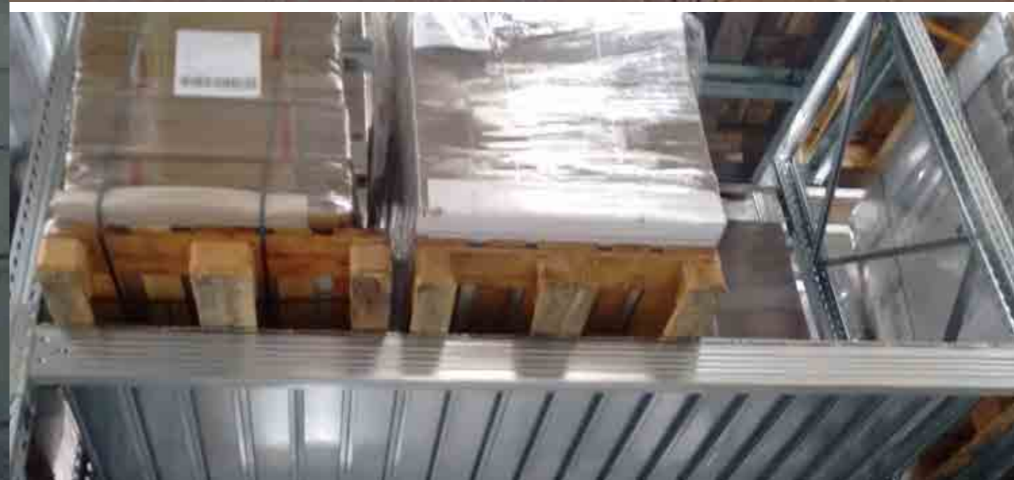
A sinistra scaffalatura con piano accessorio con pianetti di chiusura. In alto il particolare di porta pallet con piano di carico realizzato in grigliato forato zincato. In basso un tunnel di attraversamento (protetto con pianetti di chiusura) pedonabile e carrabile.
