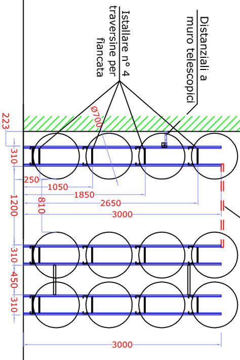
Collegamenti superiori con angolare 35x35 da tagliare a misura in fase di montaggio
