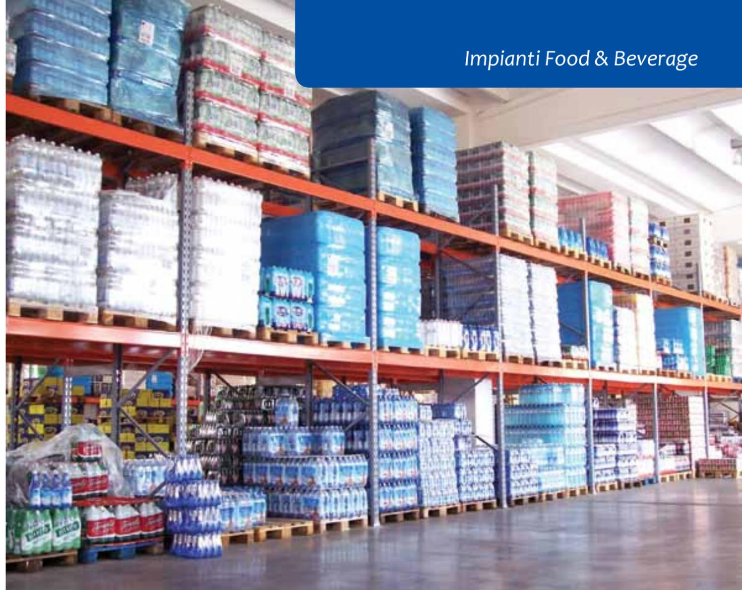
In queste immagini evidenziamo i magazzini di operatori settore Food & Beverage, che grazie alle nostre soluzioni tecniche funzionali, riescono con estrema semplicità a collocare pallets di peso superiore ai 1200Kg sulle travi portanti realizzate per sostenere anche carichi accidentali dovuti da un improprio utilizzo di carrelli elevatori.
