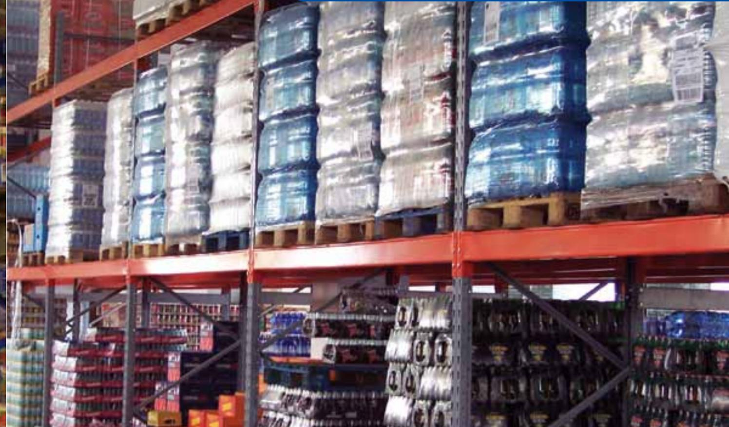
Presentiamo il nostro **modello E80 porta pallets** dalle eccellenti caratteristiche strutturali, realizzato con lamiere ad alto resistenziale, gli spessori del montante raggiungono i 25/10, davvero un **dato che ci pone ai vertici sul mercato internazionale** per la solidità dei nostri impianti.
