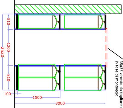
Collegamenti superiori con ancore 35x35 zincato da tagliare a cura cliente In fase di montaggio
